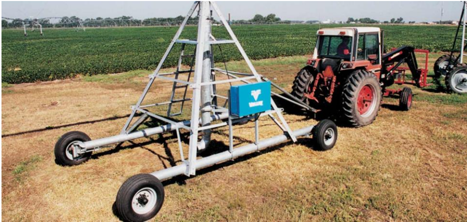
Figura 9 – Pivô rebocável acoplado ao trator para deslocamento entre áreas. Fonte: Valley Irrigation (2021b).
